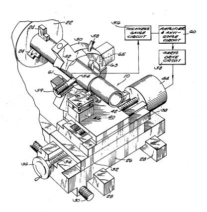
ىخ THICKNESS AMPLIFIER ¢ ANTI-GOUGE CIRCUIT GAUGE CIRCUIT SERVO DRIVE 8ى Ⅲण  $\mathbb{V}^{|\mathbb{N}|}$
