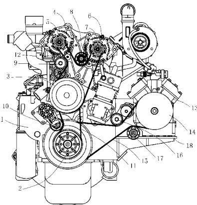
1. WP10 客车发动机空调搭载传动机构,包括设置于发动机壳体一端的曲轴双联皮带轮,所述曲轴双联皮带轮的上方设有水泵双联驱动轮,所述水泵双联驱动轮与曲轴双联皮带轮通过第一传动带相连接,其特征在于:所述水泵双联驱动轮一侧的发动机壳体上固定安装有空调压缩机,所述空调压缩机连接压缩机皮带轮,所述压缩机皮带轮与曲轴双联皮带轮通过第二传动带传动连接。
