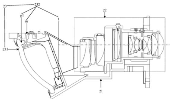
1. 一种投影镜头,其特征在於,所述投影镜头包括底座以及位於所述底座中的折射镜组和反射机构;
