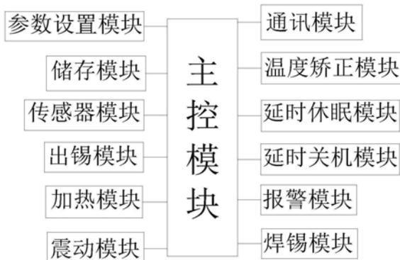
1. 一种焊台温控系统,其特征在于,该系统包括终端、服务器和两个以上的焊台,所述焊台均包括焊锡模块、主控模块、参数设置模块、储存模块和通讯模块,所述主控模块均与服务器通讯连接;其中:
