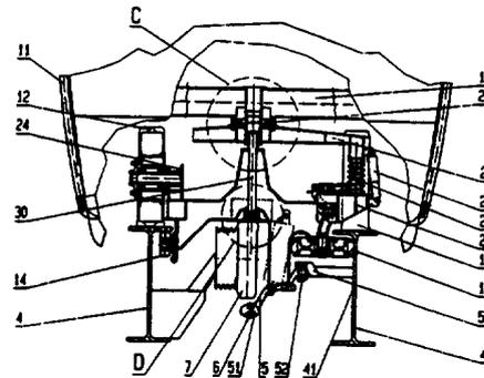
Die gegenständliche Erfindung betrifft ein Fahrzeug mit mindestens zwei Fahrgestellen, welche eine Fahrgastkabine tragen, und welches mit einer Klemmeinrichtung ausgestattet ist, mittels welcher es an ein Förderseil ankuppelbar ist, wodurch es längs einer Fahrbahn, insbesondere längs Schienen, verfahrbar ist, wobei jedes Fahrgestell einen oberen Rahmenteil und einen unteren Rahmenteil aufweist, zwischen welchen
