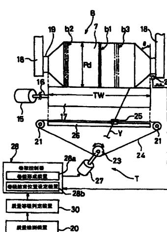
1、一种纱条加工装置，具有对纱条进行加工的纱条加工部，以及卷取加工后的纱条形成卷装的纱条卷取部，其特征在于，
