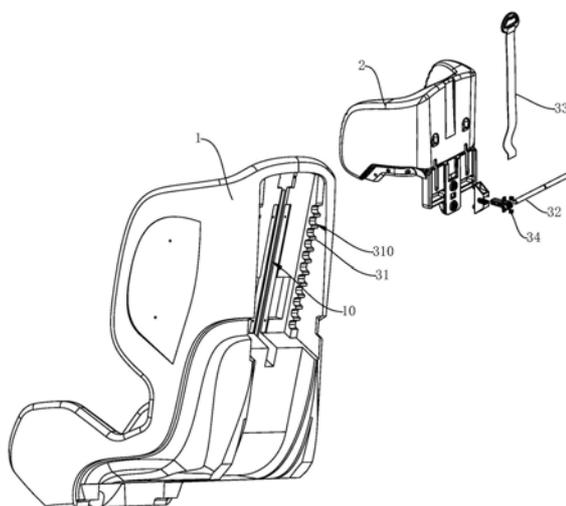
1. 一种头枕可调节的安全座椅,包括椅背、可滑动地设于所述椅背的头枕,以及用于锁定或解锁所述头枕移动的头枕调节结构,其特征在于,所述头枕调节结构包括:
