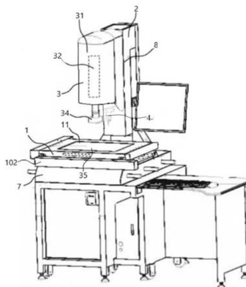
1. 一种多功能测量仪器,其特征在于:包括安装在基座(7)上的测量工作台(1)、立柱(2)、影像测量系统(3)和三坐标测头(4),位于测量工作台(1)上方的影像测量系统(3)包括影像镜套筒(31)、位于影像镜套筒(31)中的CCD摄像机(32)和平行光源(33),所述三坐标测头(4)安装在影像镜套筒(31)一侧,且所述影像镜套筒(31)和三坐标测头(4)均通过一Z轴驱动机构(8)安装在立柱(2)上,所述三坐标测头(4)的探头(41)的转轴不高于影像测量系统(3)底面,且此三坐标测头(4)与影像测量系统(3)的间距大于三坐标测头(4)的探头(41)的长度,所述测量工作台(1)顶面嵌有一玻璃板(11),此玻璃板(11)上方安装有一定位夹具(6),此定位夹具(6)包括定位板(61)和定位杆(63),所述定位板(61)上开有多个螺孔(62),所述定位杆(63)底部螺纹插接于螺孔(62)中,此定位板(61)通过螺栓(64)与测量工作台(1)连接。
