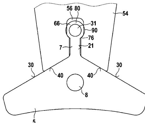
1. 电机(71)的定子(1),尤其是用于以电动方式调节机动车中的可活动的部件,包括定子环(2),在该定子环上布置有用于接纳电绕组(3)的定子齿(14),其中,该定子齿(14)具有沿径向延伸的齿颈(54),在齿颈的径向端部处布置有齿尖(5),其特征在于,每个单个的齿尖(5)设计成单独制造的部件,该部件在电绕组(3)被施加到齿颈(54)上之后可以被固定在齿颈处。
