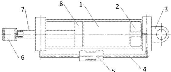
1. 一种气囊补偿分体式磁流变液座椅阻尼减振器，包括液压缸(1)，外置励磁单元(5)和补偿气囊(2)，其特征在于：所述液压缸(1)和外置励磁单元(5)采用分体式设计分体放置，所述补偿气囊(2)固定在液压缸(1)缸体内部的底端，作为活塞杆空程补偿。
