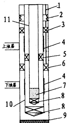
1、一种液控式同心双管分注管柱，包括液控管线、水力锚、上液控封隔器、筛管、定位密封插头、下液控封隔器、内筛管、丝堵、油管、内管和套管，其特征在于所述套管内下入外管，该外管上顺次连接有水力锚、上液控封隔器、筛管、下液控封隔器、筛管和丝堵，所述外管中下入内管，该项内管上顺次连接有定位密封插头、内筛管和堵头，所述液控管线管线安装于套管和外管之间的环空内，顺次与水力锚、上液控封隔器和下液控封隔器相连接。
