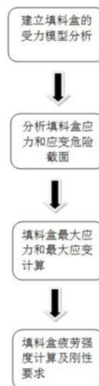
1. 大型往复压缩机高压填料盒的应力和应变计算方法, 其特征在于, 包括以下步骤:
