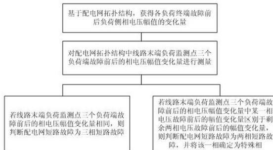
1. 基于负荷端相电压幅值变化量的配电网短路故障判断方法, 其特征在于, 包括有如下步骤:
