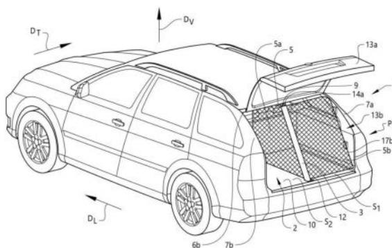
1. 一种可折叠的车笼架系统(1),所述可折叠的车笼架系统(1)被布置成用于对内部车辆行李舱(2)进行划分,其中,所述车笼架系统(1)包括笼架柱(3)、细长引导部件(4)和网状结构(5),其中,所述网状结构(5)连接至所述笼架柱(3),所述笼架柱(3)的第一端(3a)滑动地且铰接地连接至所述细长引导部件(4),并且所述细长引导部件(4)被构造成连接至第一车辆内部结构(6a),
