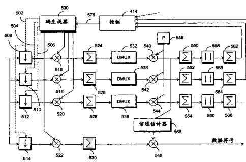
1.一种用于码跟踪瑞克接收机分支的方法，在所述方法中，通过使用码相位捕获方法为所述瑞克接收机分支设置延迟值，
