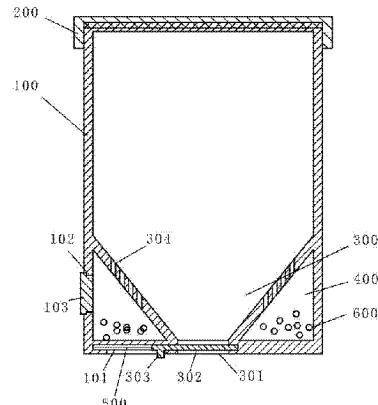
1. 一种茶叶盒，其包括盒体和盖在盒体上的盒盖，其特征在于：所述盒体内下部具有漏斗空腔和环绕漏斗空腔底部的干燥剂空间，所述漏洞空腔壁上具有与干燥剂空间相通的透气孔，所述干燥剂空间放置有干燥剂，在盒体底部对应漏斗空腔的下端的位置具有一个出茶口，该出茶口上设有一个盖板。
