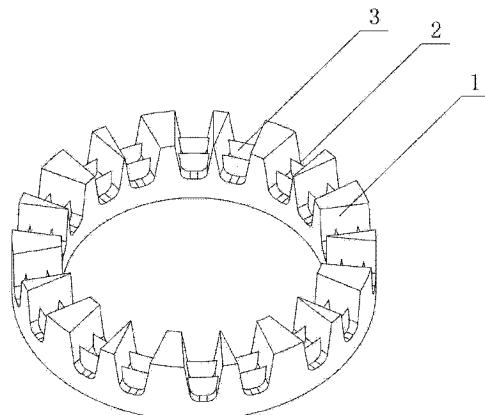
1. 一种钻头加工用模具,其特征在于:包括锯齿环(1)和一个以上的易磨损材料制成的同心环(2),所述锯齿环(1)上设有两个以上沿圆周方向依次排列的用来成型钻齿(5)的齿槽(7),所述锯齿环(1)沿着径向方向依次开设有一个以上的圆环孔(3),所述同心环(2)插设于同等直径处的圆环孔(3)中。
