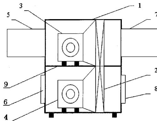
1. 一种无压缩一体式空气调节设备,适于室内外空气隔绝的房间,在室外温度低于室内温度时,对房间内空气降温使用,其特征在于,其结构包括机箱、风机和热管换热器;其中,机箱内部分为上下两室,上下两室由中间隔板作气体隔绝;上箱室设置室外风道,下箱室设置室内风道;设置热管换热器纵穿上下箱室,热管换热器机芯内充有制冷工作介质;上下箱室分别设置风机,风机装置的位置和风吹方向适于箱室内空气经过热管周围流出箱室。
