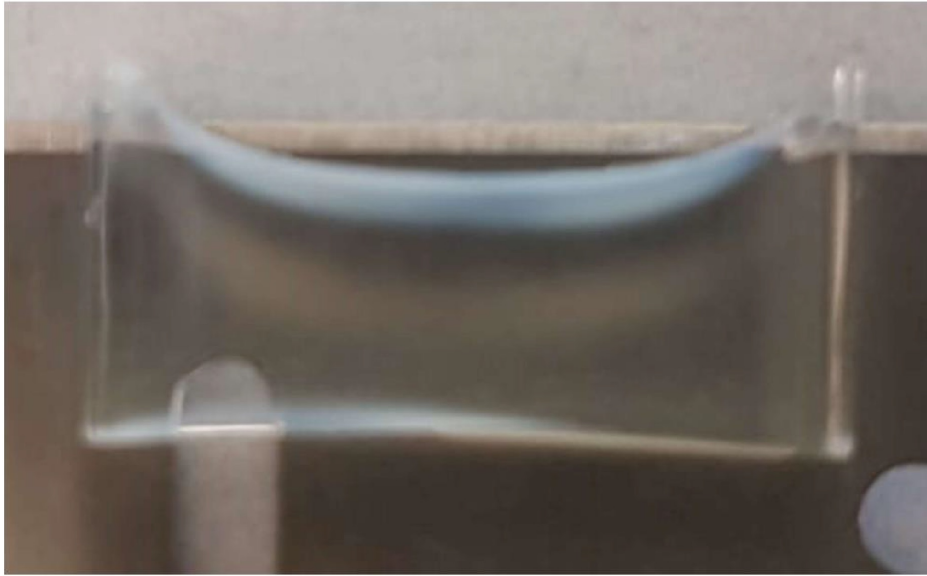
Фиг. 1. Фотография глубины минерализации в поперечном сечении в примере 11 через 12 суток. Видимый снизу вогнутый срезанный край образца геля представляет собой минерализованную область (молочно-белый цвет). Ниже на некотором расстоянии видна следующая область минерального материала (бледно-серый цвет).
