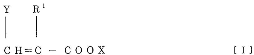
[式 [I] 中、X は水素原子、アルカリ金属原子またはアンモニウム基を示し、Y は水素原子または  $C O O X$  基を示し、 $R^1$  は水素原子またはメチル基を示す] で表される不飽和カルボン酸またはその塩とキノン類とを、重合開始剤の存在下に共重合して製造された数平均分子量が  $500 \sim 1,000,000$  の不飽和カルボン酸重合体。
