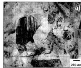
FIG. 44a) 広範囲の再結晶を示す大結晶粒を呈する、650°Cで10分間焼きなましされた合金1試料の明視野TEM画像・低倍率画像。
