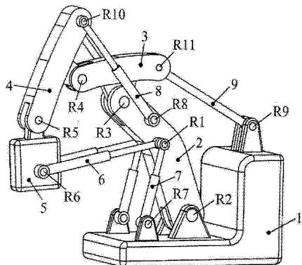
1. 一种含有加长臂和复铰的三自由度多环耦合机构,其特征在于:底座(1)上设有三对平行对称的基座,其中间的一对基座通过铰链与大臂(2)的一端连接,该大臂(2)的另一端通过铰链与加长臂(3)的中部连接,该加长臂(3)的一端通过铰链与一个拉杆(9)的一端连接,该拉杆(9)的另一端通过铰链与底座(1)一端的一对基座连接;上述加长臂(3)的另一端通过铰链与小臂(4)的中部连接,该小臂(4)的一端通过铰链与末端执行器(5)上的一个部位连接;其另一端通过铰链分别与一对小臂油缸(8)的活塞杆端部连接,该小臂油缸(8)的缸套端部通过铰链与大臂(2)连接;上述末端执行器(5)分别通过铰链与一对末端执行器油缸(6)的缸套端部连接,大臂(2)的一侧与一个末端执行器油缸(6)的活塞杆端部和一个大臂油缸(7)的活塞杆端部通过铰链连接而构成一个复合铰链,上述大臂(2)的另一侧也通过上述的连接方式形成一个复合铰链,上述两个复合铰链在大臂的两侧呈对称布置;上述大臂油缸(7)的缸套端部通过铰链与底座(1)上另一端的一对基座连接。
