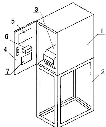
1. 一种自动扫描标签剥离机,包括箱体(1)和底座(2),其特征在于:所述箱体(1)中设有标签打印机(3),所述箱体(1)前设有一可开合的门板(4),在门板(4)上自上而下设有触摸显示屏(5)、扫描仪(6)及剥离口(7),标签打印机(3)、触摸显示屏(5)、扫描仪(6)通过中央控制单元相联接。
