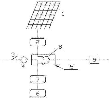
1. 一种家用储能电站，其特征是主要由太阳能电池板、光伏逆变器、双向换流器、化学储能电池和交流母线盒构成，所述太阳能电池板经过光伏逆变器与交流母线盒相连接，所述化学储能电池经过双向换流器与交流母线盒相连接，交流母线盒设有向负载供电的接口，交流母线盒内设有自动测试开关。
