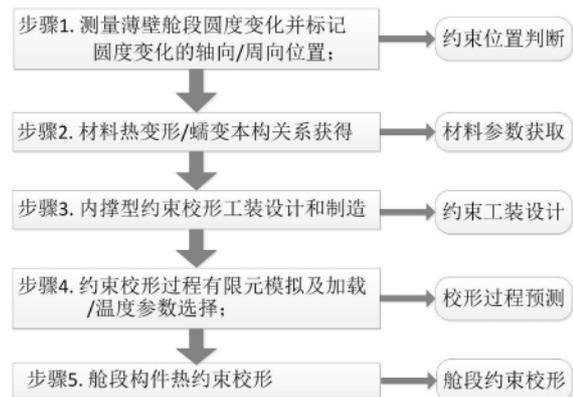
1. 一种铝镁合金薄壁舱段制造变形的校形方法,其特征在于:它包括以下步骤:
