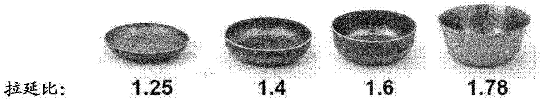
以 0.8 mm/s 采用不同拉延比拉延并暴露于氢 45 分钟之后来自合金 1 的杯的图。
