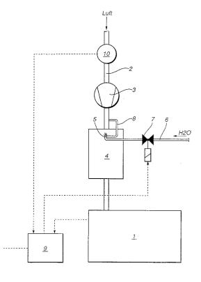
Die Erfindung betrifft ein Verfahren und eine Vorrichtung zur Befeuchtung von Prozeßgas für den Betrieb von Brennstoffzellensystemen gemäß dem Oberbegriff des Patentanspruchs 1.
