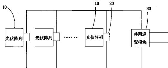
1. 一种光伏电源系统结构,其特征在于:所述光伏电源系统结构包括若干光伏阵列、若干控制模块、以及一并网逆变模块,所述控制模块包括:
