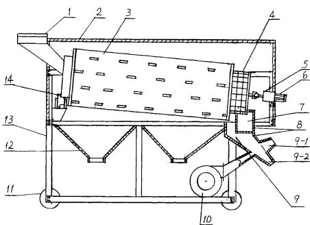
1、一种粮食杂物清除机，包括框架（13）、滚筒筛（3）（4）、电机（6）组成，其特征是在框架（13）上装有壳体（2），壳体（2）内装有内、外滚筒筛（4）、（3），该滚筒筛一端装在框架（13）一侧，一端装在框架（13）另一侧，由电机（6）传动转动，在内、外滚筒筛（4）、（3）前端有进料口（1），后端出料处有出料口（8）装在框架（13）上，鼓风机（10）接通出料口（8），在内、外滚筒筛（4）、（3）下面固定有储尘仓（12）。
