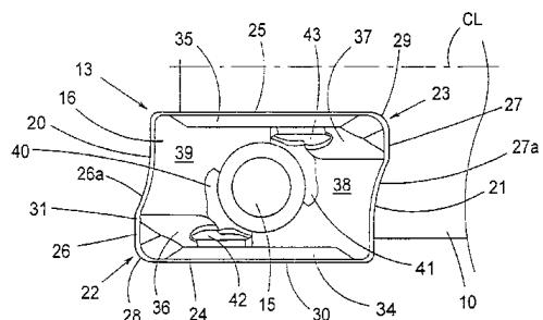
1. 用于切屑成形加工的切削刀片，包括一基本为多边形的本体，该本体包括一上部切屑面（16）和一平的底面（17），以及位于其间的多个周边侧表面（18，19，20，21），该多个周边侧表面（18，19，20，21）在所述上表面的交会处形成了主和副切削刃（24，25，26，27），其中每个刃具有一斜面（30，31），所述副切削刃设置在从刀片本体其余部分轴向突出的部分（22，23）上，其中纵向延伸的表面（18，19）朝起作用的切削角部具有增大的宽度，从而使切削角部位于一升高的部分上，倾斜表面（34，35）从所述斜面（30，31）内向延伸，一个或几个上部切屑面设置在所述倾斜表面内侧并向刀片的中心延伸，从而在其间提供切屑卷曲区，其特征在于：
