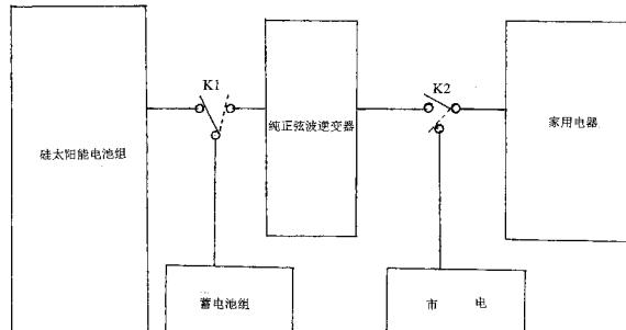
1. 一种家用的太阳能光伏电源装置,其特征在于:太阳能光伏电源装置由硅太阳能电池组、蓄电池组、纯正弦波器和各种家用电器组成。
