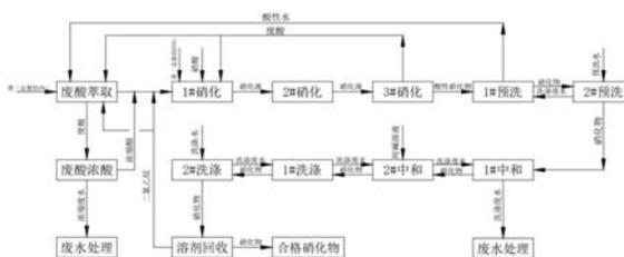
1. 连续低温硝化制备1-硝基萘的工艺,其特征在于,主要包含有硝化、预洗、中和、洗涤工序,硝化装置由三台硝化釜、一台废酸萃取釜、两台预洗釜、两台中和釜、两台洗涤釜串联而成,三台所述硝化釜包括1#硝化釜、2#硝化釜和3#硝化釜,两台所述预洗釜包括1#预洗釜和2#预洗釜,两台所述中和釜包括1#中和釜和2#中和釜,两台所述洗涤釜包括1#洗涤釜和2#洗涤釜,具体步骤如下:
