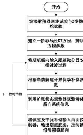
1. 一种波浪滑翔器变航速下自适应艏向控制器,由三部分串联结构组成,分别为跟踪微分器TD、扩张状态观测器与曲面控制器,其特征是:所述扩张状态观测器中的扰动补偿参数 $b$ 根据波浪滑翔器的当前航速进行实时调节,扰动补偿参数 $b$ 为波浪滑翔器潜体艏向非线性一阶KT方程中 $K$ 与 $T$ 的比值,在不同航速下利用相似原理得到扰动补偿参数 $b$ ;所述扩张状态观测器实时估计系统的总干扰,并调节曲面控制器的曲面偏移值进行干扰补偿。
