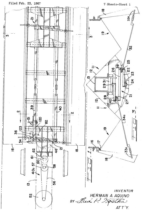
MANUAL OR TRACKWAY CAM HOPPER CAR DOOR OPERATING MECHANISM
