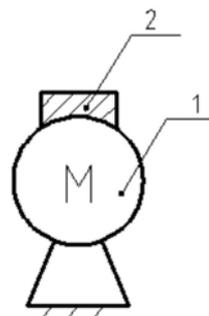
1. 一种具有封星功能的曳引机系统,其特征在于,包括曳引机和封星装置,曳引机和封星装置两者电路连接且直接或间接物理连接,当曳引机处于失电工况时,该封星装置将曳引机线圈的三相短接,产生封星动作。
