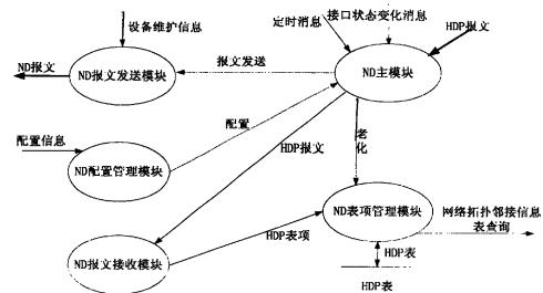
1、一种网络设备的邻居发现方法，其特征在于，网络设备周期性地向邻接设备发送同一种的邻居发现报文，同时接收网络中其它邻居设备发送的邻居发现报文，各网络设备根据接收到的邻居发现报文采集邻接设备信息，存储和维护邻居信息。
