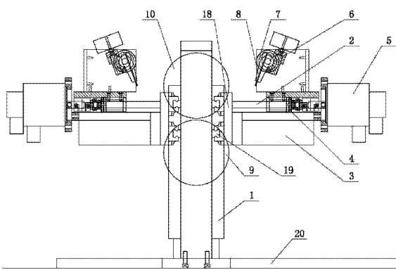
1. 一种精密数控双磨头宝石滚磨成型机，包括研磨系统和驱动系统，所述的研磨系统包括磨头，磨头由进刀移动机构、摆角机构、转角机构、升降机构、气动机构组成，气动机构安装在铝排座上，对铝排进行夹紧，进刀移动机构设置在磨头底板上，升降机构安装在底座上，升降电机带动整个磨头作上下移动，摆角机构和转角机构安装在支座上，完成对铝排的摆角动作和转角动作，其特征在于：所述的研磨系统还包括磨辊，磨辊轴向与铝排平行设置，磨辊与驱动系统连接；
