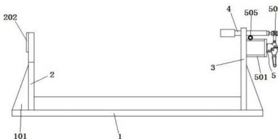
1. 一种水滴形烤炉切割工装,其特征在於:包括底座(1)、支撑板A(2)、支撑板B(3)、支撑轴(4)及限位机构(5);所述支撑板A(2)及支撑板B(3)连接于底座(1)的两端,支撑板A(2)上设有卡槽A(201),支撑板B(3)上设有卡槽B(301),支撑轴(4)滑动配合于卡槽B(301);所述限位机构(5)连接于支撑板B(3)上,限位机构(5)上设有限位块,在工作状态下,限位块与支撑轴(4)同心设置。
