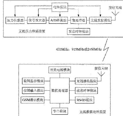
1. 一种无线压力实时监控系统主要由无线压力传感装置和无线数据处理装置组成，无线压力传感装置与无线数据处理装置之间通过无线方式进行通讯连接，其特征在于，所述无线压力传感装置包括依次连接的压力传感器、信号放大器、A/D 转换器、微处理器和无线发射模块，在无线发射模块上接有发射天线，在微处理器上还接有发送时钟模块，所述无线压力传感装置的压力传感器、信号放大器、A/D 转换器、微处理器和无线发射模块分别与电池模块连接供电，所述无线数据处理装置包括智能控制器和分别与智能控制器连接的数码显示模块、按键输入模块、GSM 通讯模块、无线接收模块、接收时钟模块、RS485 模块、串口模块及开关电源模块，在无线接收模块上接有接收天线，所述串口模块包括数据接口，为 RS485 接口、RS232 接口、USB 接口中的一种或几种。
