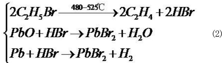
式(1)的 $(\text{CH}_3\text{CH}_2)_4\text{Pb}$ 分解在 $200^\circ\text{C}$ 开始出现,接近 $300^\circ\text{C}$ 时 $(\text{CH}_3\text{CH}_2)_4\text{Pb}$ 分解产物充分参与焰前反应发挥抗爆作用,在 $500\sim 600^\circ\text{C}$ 时 $(\text{CH}_3\text{CH}_2)_4\text{Pb}$ 分解趋于完全;式(2)的 $\text{C}_2\text{H}_5\text{Br}$ 分解在 $480\sim 525^\circ\text{C}$ 开始出现。两个反应式对温度的不同需求保证了抗爆和排铅两个反应发生的先后顺序。
