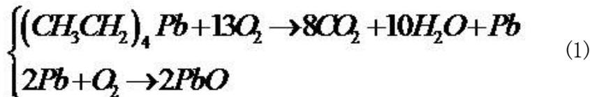
为避免或降低 $\text{PbO}$ 和 $\text{Pb}$ 沉积对发动机造成影响,在燃油中又按比例加入排铅剂 $\text{C}_2\text{H}_5\text{Br}$ 与 $\text{PbO}$ 或 $\text{Pb}$ 反应生成熔点和沸点都很低的 $\text{PbBr}_2$ 随废气排出,反应式为
