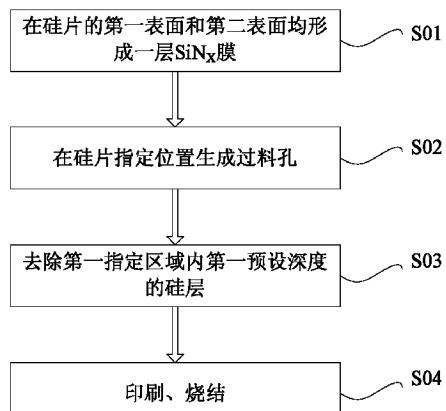
1. 一种去除带有背场结构 MWT 太阳能电池的背场的方法, 背场结构位于硅片的第一表面, 其特征在于, 包括步骤:
