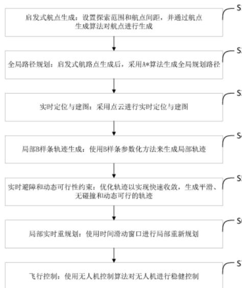
1.一种基于四旋翼无人机的高效自主探索方法,其特征在于,利用启发式航点生成方法,基于该航点,创建一条完整的全局路径,包括水平和垂直方向上的航点;随后,采用非线性优化,使用B样条曲线生成平滑、无碰撞且动态可行的局部规划轨迹;最后,当检测到树干、树枝障碍物时,利用滑动窗口策略快速调整轨迹;
