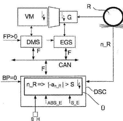
1. 用于识别机动车的驱动系统中的故障的方法,其具有可电子控制的制动调节系统和至少一个可电子控制的驱动发动机(VM)和/或可电子控制的离合器和/或可电子控制的传动装置(G),其中,制动调节系统配设有电子制动控制设备(DCS),所述电子制动控制设备与独立的监控模块( $\ddot{U}$ )连接,其中,所述独立的监控模块( $\ddot{U}$ )检验不可信的制动力矩的出现以识别驱动系统中的故障。
