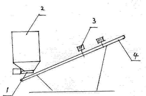
1. 一种碎玻璃给料装置，设有传送带，其特征在于：在传送带进料端的上方设有给料料斗，给料料斗设有向下的出料口，在出料口处装有振动给料装置，在传送带的中部设有磁选机构。
