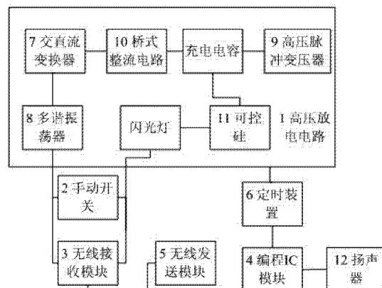
1. 一种新型电子鞭炮,它包括由若干个鞭炮单体组成的鞭炮串,其特征在于:所述鞭炮单体内设置有高压放电电路,所述高压放电电路连接有外设于鞭炮单体的电源插头,所述电源插头内设置有控制高压放电电路导通的手动开关和无线接收模块,所述高压放电电路还连接有编程 IC 模块,所述编程 IC 模块连接有扬声器;
