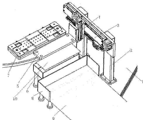
1. 一种麦拉纸传送装置兼收料装置,其特征在于 :包括 :固定在台面(1)上的支架(2),所述支架(2)上设置有滑轨(3),所述滑轨(3)上设置有滑块(4),所述滑块(4)与吸板(5)的一端连接,所述吸板(5)的下方设置有麦拉纸盒(6)、物料板(7)和收料装置(8),所述吸板(5)与所述滑轨(3)相垂直设置,物料板(7)位于所述麦拉纸盒(6)的前方,所述收料装置(8)位于所述麦拉纸盒(6)的后方。
