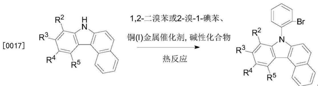
[0018] 将所述7-(2-溴苯基)-8,9,10,11-四取代-7H-苯[c]咪唑溶于第二有机溶剂中, 加入正丁基锂和二取代氯膦形成反应体系2, 取代反应制备7-(2-二取代膦苯基)-8,9,10,11-四取代-7H-苯[c]咪唑膦配体, 其反应式如下所示,
