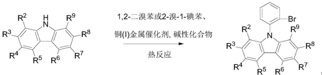
将所述9-(2-溴苯基)-1,2,3,4,5,6,7,8-八取代-9H-咪唑溶于第二有机溶剂中, 加入正丁基锂和二取代氯膦形成反应体系2, 取代反应制备9-(2-二取代膦苯基)-1,2,3,4,5,6,7,8-八取代-9H-咪唑磷配体, 其反应式如下所示,
