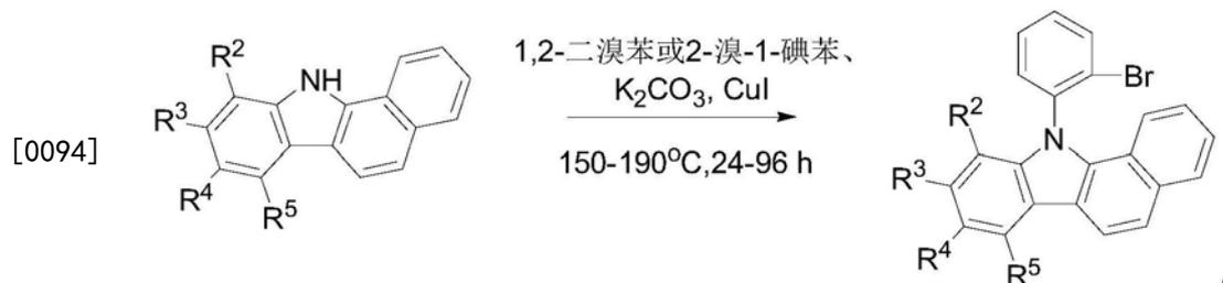
[0095] 进一步的,为了获得纯度高的11-(2-溴苯基)-7,8,9,10-四取代-11H-苯[a]咪唑,所述热反应完全后把铜粉滤走,然后在减压的情况下加热抽走第一有机溶剂,经柱层析纯后得11-(2-溴苯基)-7,8,9,10-四取代-11H-苯[a]咪唑。
