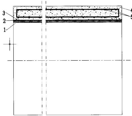
1. 玻璃钢混凝土复合管,包括玻璃钢内衬管、界面胶、钢筋笼、混凝土,其特征是:以玻璃钢内衬管为内衬,玻璃钢内衬管外壁施涂界面胶,界面胶外表面放置钢筋笼并浇筑混凝土。
