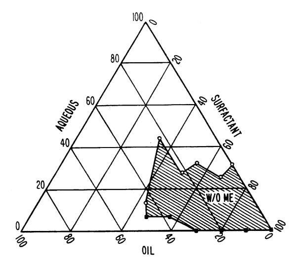
OIL: WITEPSOL H-IS SURFACTANT: (CAPMUL: MYVEROL: TWEEN)(15.4:8.5:76.0) AQUEOUS: 20% SORBITOL IN 0.9% NaCl(w/w)
