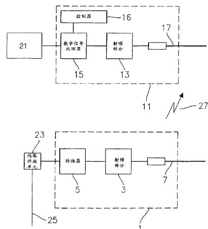
1. 一种传送传输数据的方法，所述传输数据在一模拟电话连结（25）及一数据处理使用者装置（21）之间传送，以及此方法采用一无线电话的一基站（1），其连接至所述电话连结（25）、耦接所述使用者装置（21）的一移动站（11）、及用于所述无线电话基站（1）及所述移动站（11）之间的一无线接口（27），所述方法具有下列步骤：
